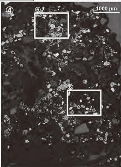
写真図版4 鉄滓の顕微鏡組織
