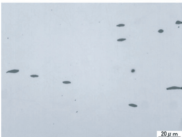
図版V-10 鎌 (シ4-6) 断面の金属組織 (2)
