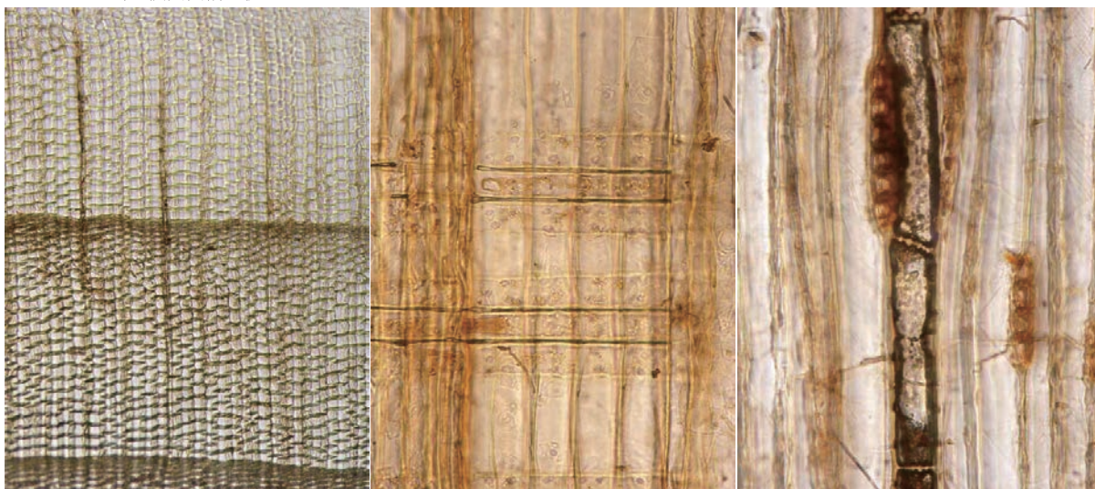
横断面 0.1mm放射断面 0.1mm接線断面 0.1mm 3. サワラ 第4検出面溝2 杭No.19
