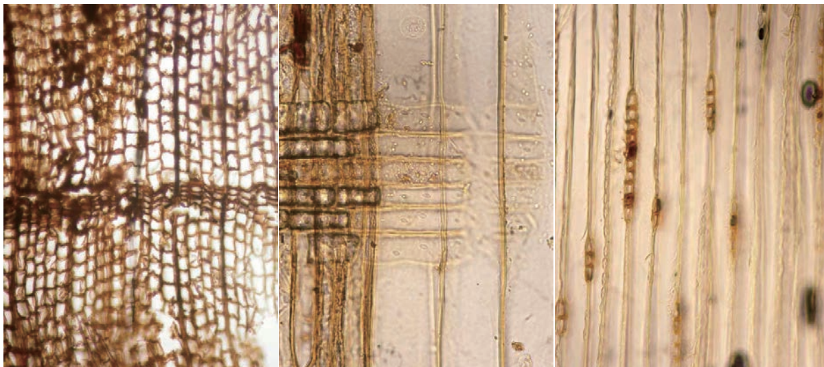
横断面 0.1mm放射断面 0.1mm接線断面 0.1mm 1. サワラ 第4検出面溝2 杭No.14
