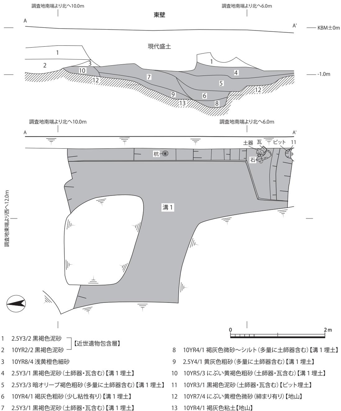
図57 遺構平面及びA-A' 間断面図 (1:50)
