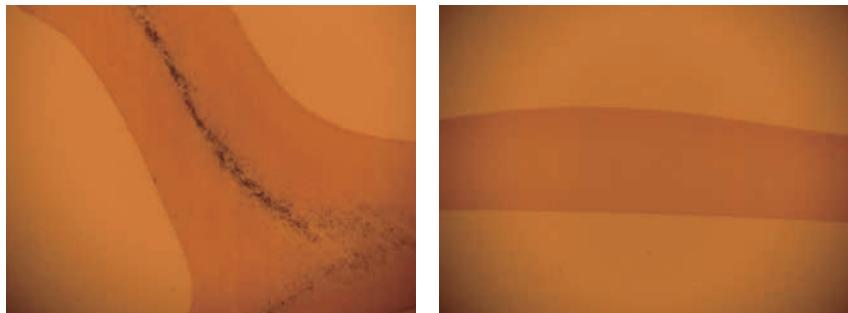
第6図 生漆・クロメ漆の漆膜断面( $\times 50$ )
