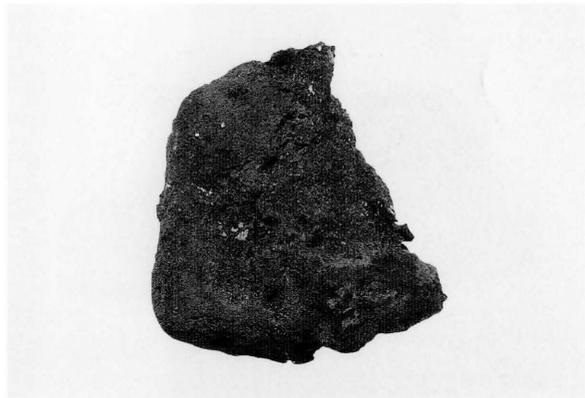
60-114 炉内滓（溶解炉・含鉄）
