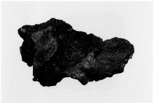
58-102 炉壁（溶解炉・接合部・含鉄）
