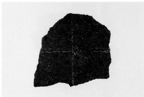
57-94 炉壁 (溶解炉・発泡)
