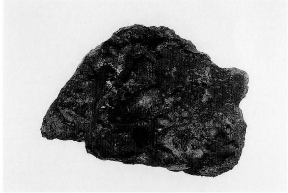
58-98 炉壁（溶解炉・炉内滓付き）
