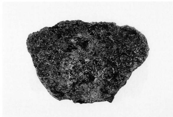
58-106 炉壁 (溶解炉・鉄粒付き・含鉄)
