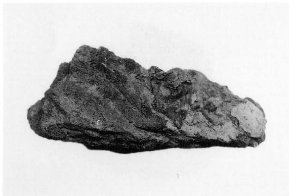
58-105 炉壁 (溶解炉・接合部・含鉄)
