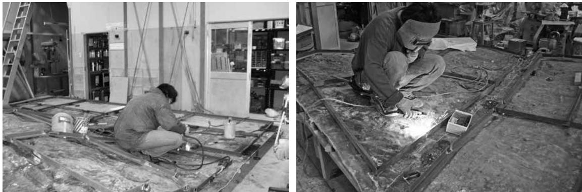
**11 脱型**…FRPをポリエスチル樹脂で硬化させて立体的位置関係を固定化し、その後、雌型とともに全体を裏返して、現地で制作した木製型枠付きのFRP雌型を取り外して、FRP雄型を制作する。
