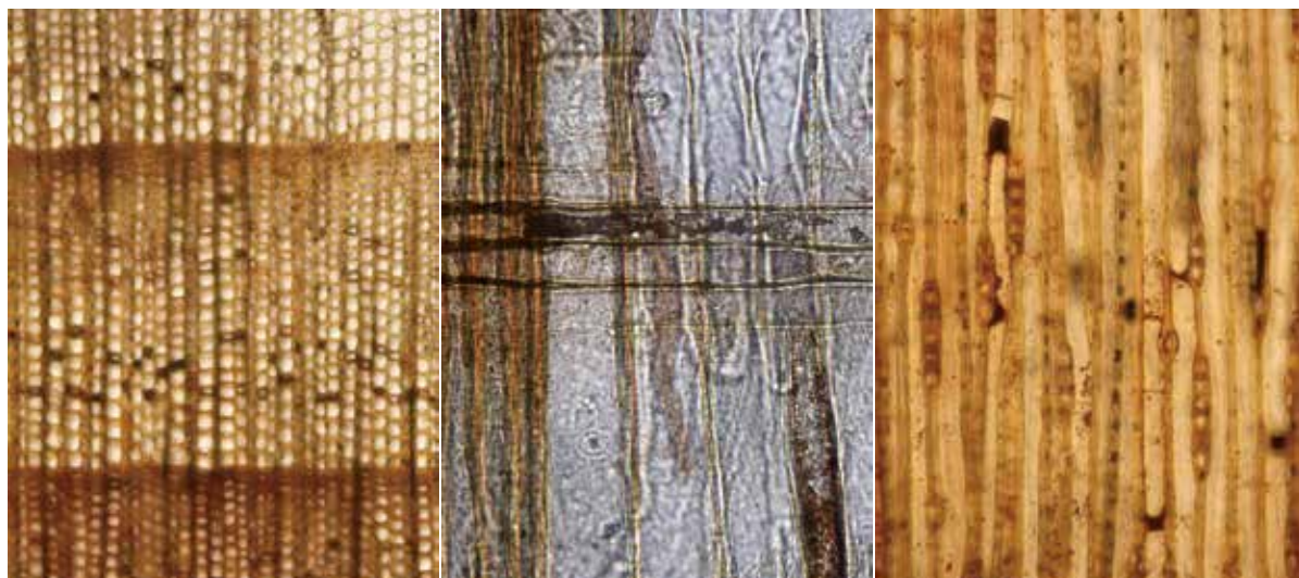
横断面 0.1mm 放射断面 0.1mm 接線断面 0.1mm 1. マキ属 取上番号1059 H28 8区 掘立柱建物(S750)出土柱根、掲載番号W91
