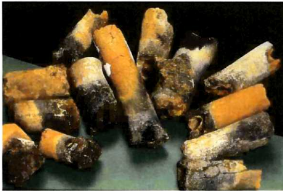
3-3 羽口（鍛冶炉に風を送るための道具）
