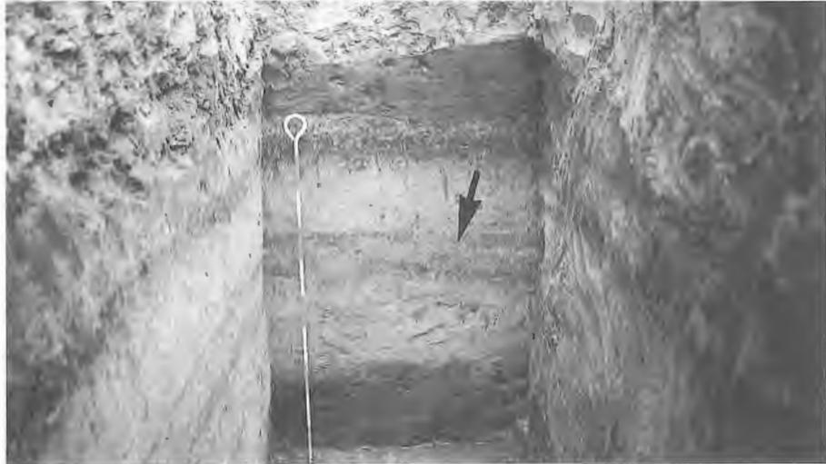
第15図 南新川公務員宿舎の試掘で発見された噴砂の痕跡
