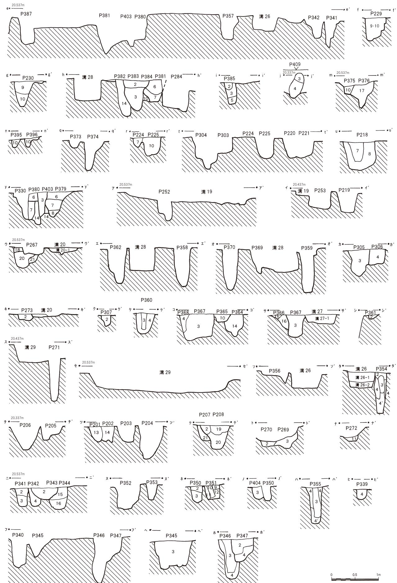
第67図 大井宿遺跡第16地点土坑③土層図2・ピット③土層図2 (1/50)
