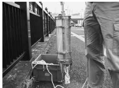
3. 北原式B号採水器（底層水採取用具）
