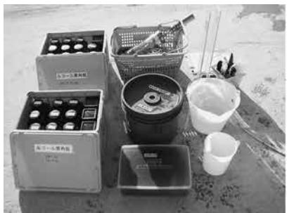
1. 試料水採取用器材・水質検査具等一式
