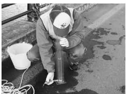
13. 透視度計による透視度の測定
