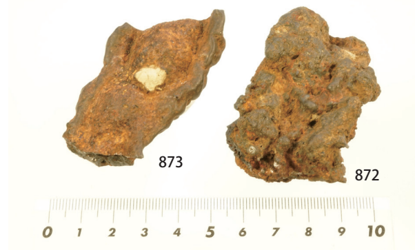
第269図 出滓孔付近の流動滓
