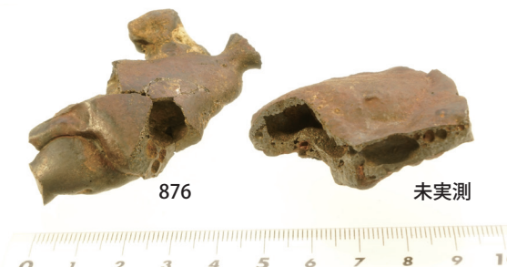
第271図 空洞・発泡痕跡のある流動滓
