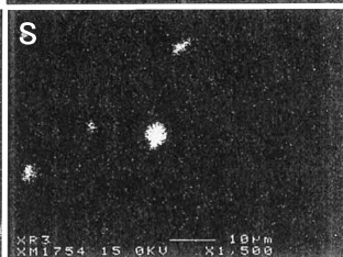
Photo.5 鉄片の顕微鏡組織
