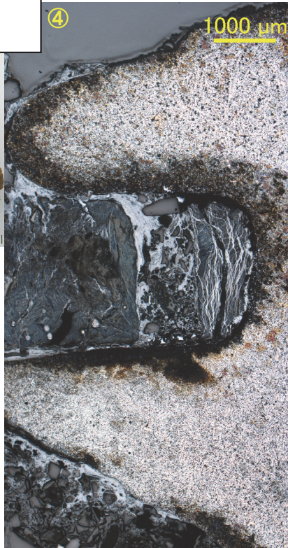
Photo. 15 鉄製品（鑄造品）・青銅製品（両端鑄鉄）の顕微鏡調査
