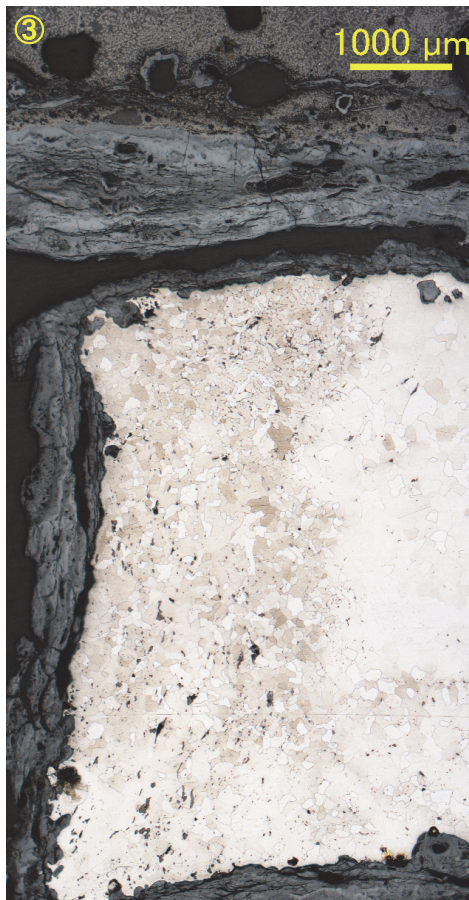
Photo. 12 椀形鍛冶滓(含鉄・鍛造品付)の顕微鏡組織
