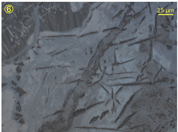
Photo. 11 鉄塊系遺物・椀形鍛冶滓(含鉄)の顕微鏡組織
