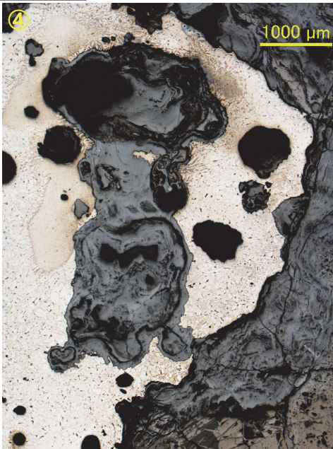
Photo. 2 炉外流出滓・鉄塊系遺物の顕微鏡組織
