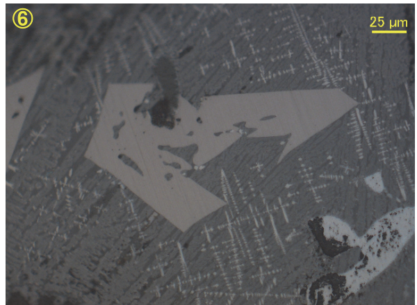
Photo. 3 羽口・椀形鍛冶滓の顕微鏡組織
