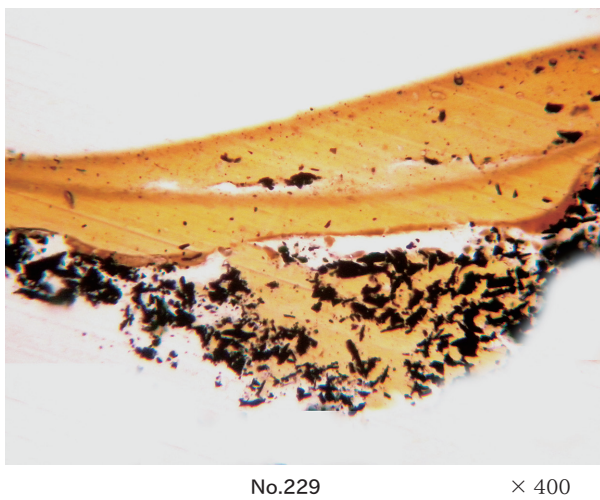
第14図 漆器塗膜層断面の顕微鏡写真(2)
