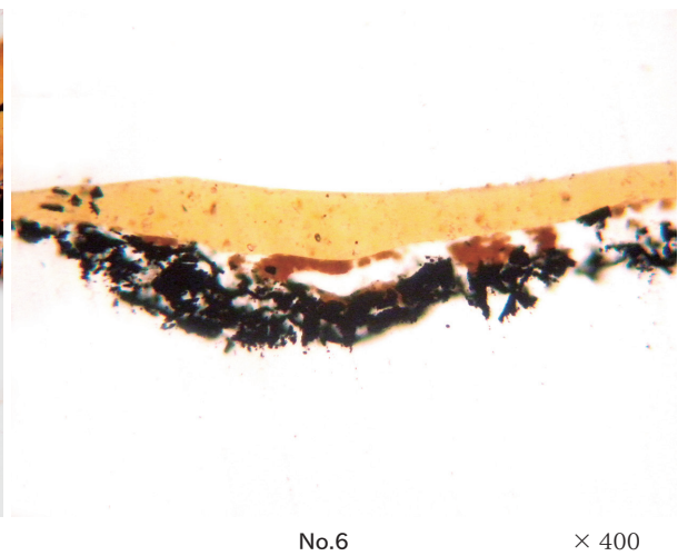
第14図 漆器塗膜層断面の顕微鏡写真(2)
