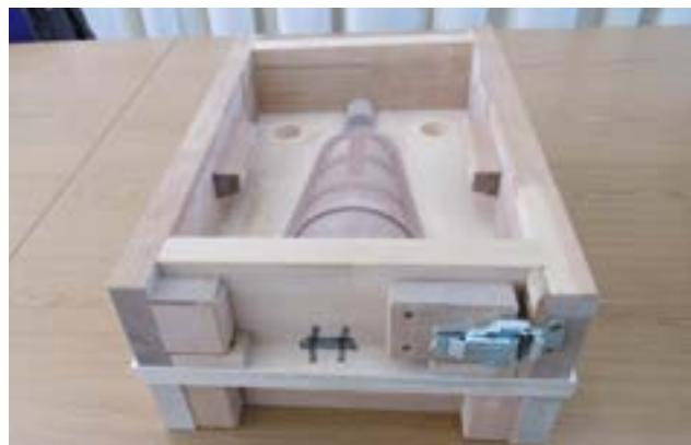
図74 鋳型の型枠(中央にあるのは銅鐸の雄型)
