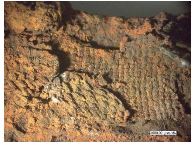
図 27. 観察箇所12-aの顕微鏡画像(複層の平織布)
