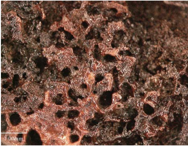
図150. 観察箇所84-aの顕微鏡画像(平織布痕跡)
