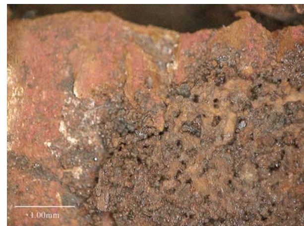
図68. 観察箇所27-aの顕微鏡画像(赤色部分上の布痕跡)
