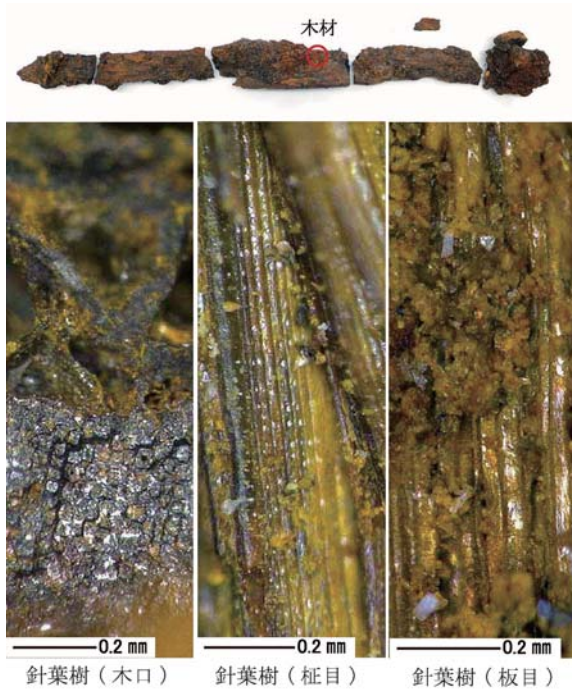
図10. 鉄剣 (No.3)の全景と付着木材の組織
