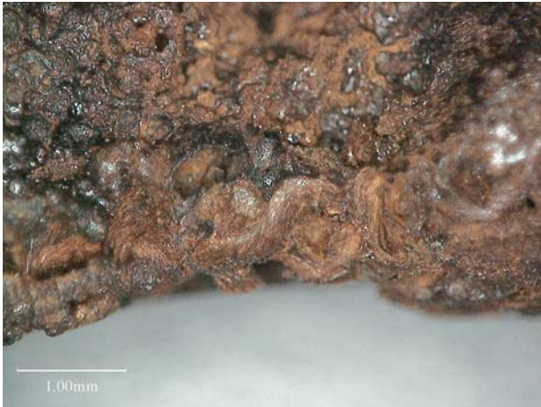
図 52. 観察箇所17-aの顕微鏡画像(布断面:図51の拡大)
