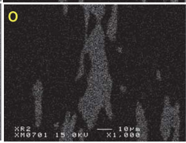
鉄中非金属介在物の反射電子像(COMP)・特性X線像
