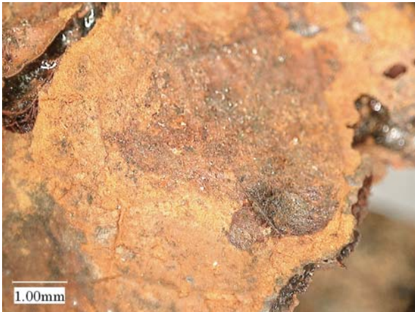
図 73. 観察箇所13-cの顕微鏡画像(葉脈状の痕跡)
