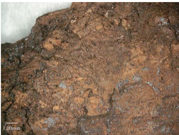
図 20. 観察箇所10-dの顕微鏡画像(布痕跡)
