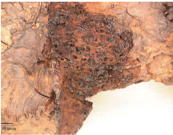
図155. 観察箇所88-aの顕微鏡画像(平織布痕跡)
