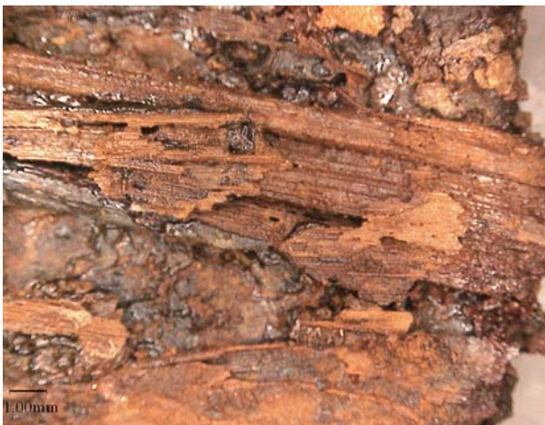
図139. 観察箇所80-eの顕微鏡画像(付着した木質)
