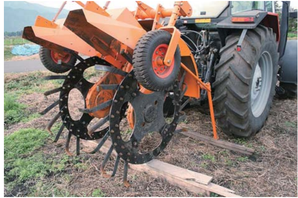
ゴボウトレンチャー(掘削部分)
