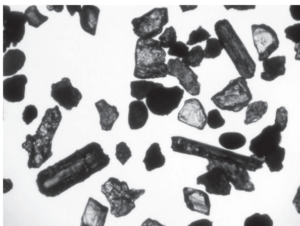
写真2 基本土層 B・IV層の顕微鏡写真 (透過光) 長柱状有色鉱物: 斜方輝石.
