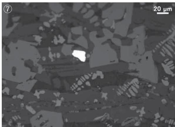
Photo.2 流出溝溝・流出孔溝・流動溝の顕微鏡組織
