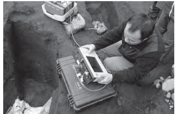
地中レーダー探査の様子②
