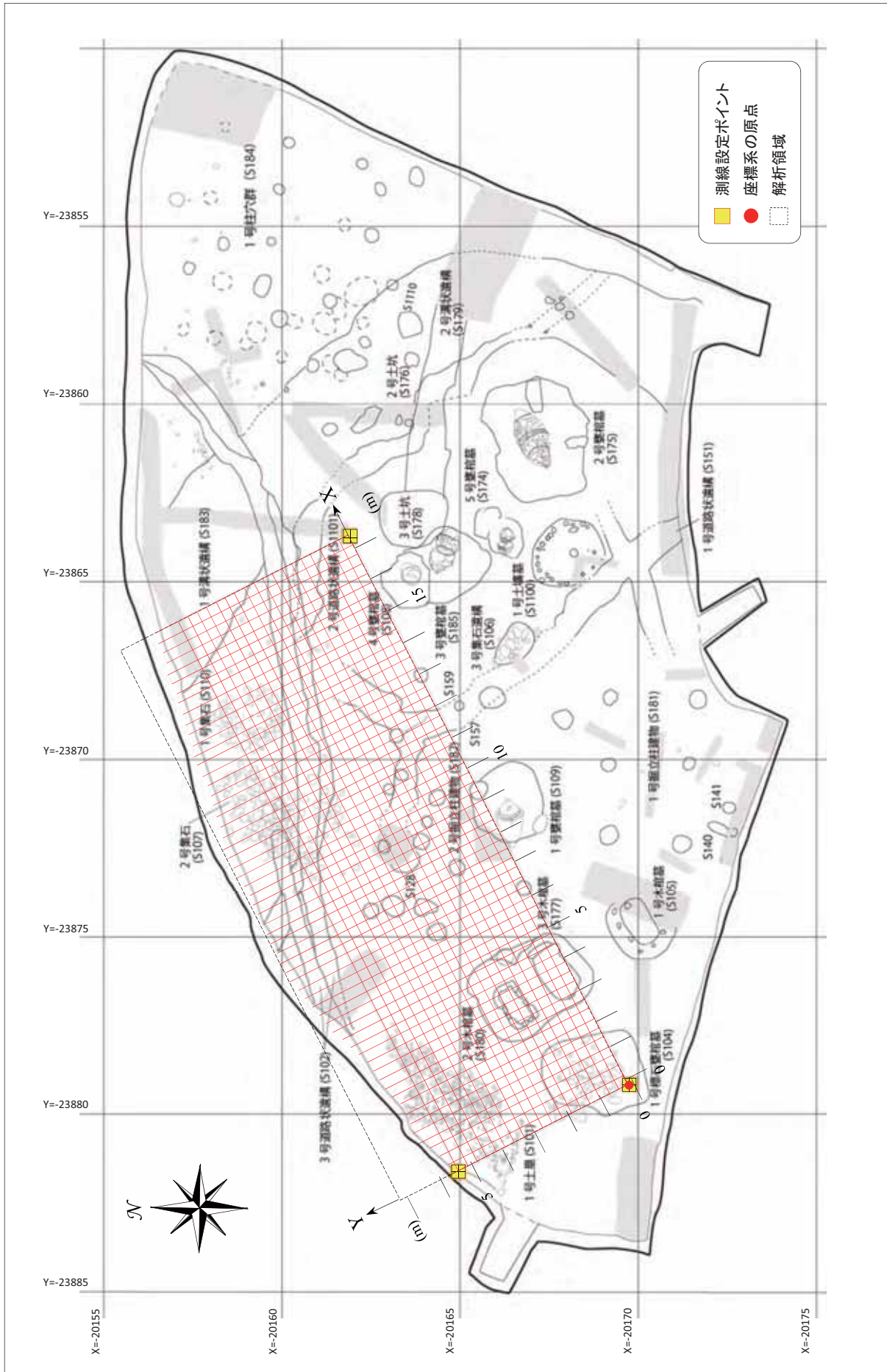
Fig.8 400MHzアンテナ用に設定された測線と座標系
