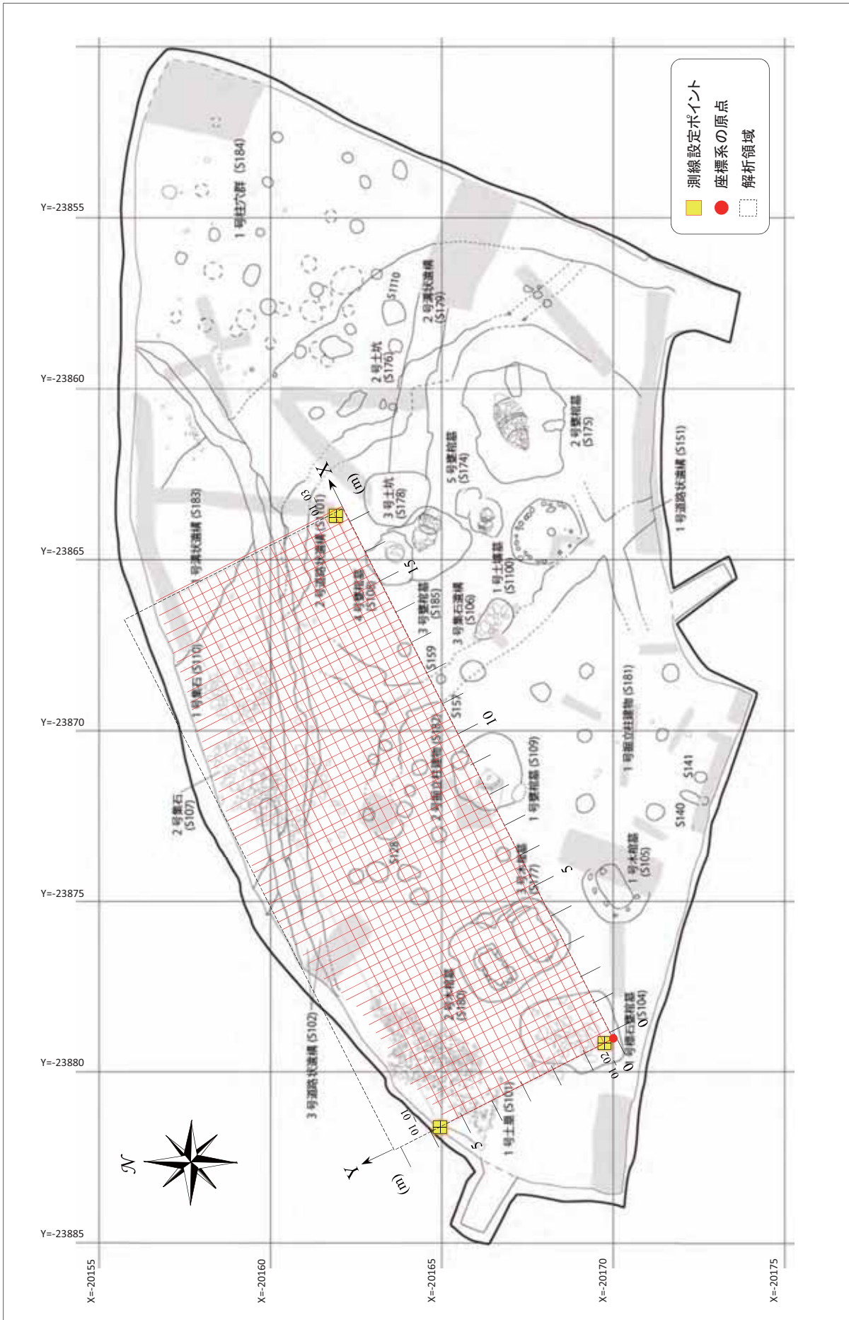
Fig.7 200MHzアンテナ用に設定された測線と座標系
