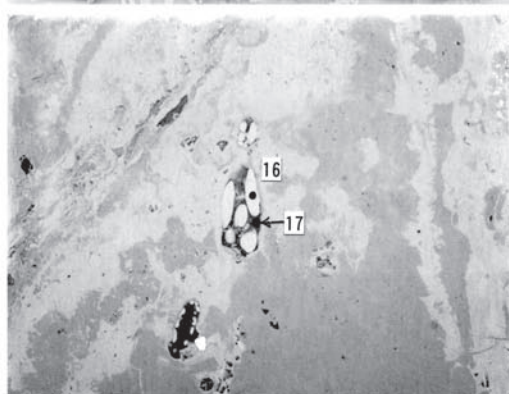
図版 47 EPMA調査結果〔反射電子像及び定量分析値〕
