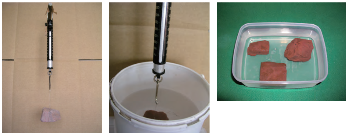
No. 1～No. 6の岩塊（凝灰岩）の比重を測定し、その結果に基づいてNo. 1、2及び4を強化剤Silicate#2に同様に1日間含浸処理。No. 3、5及び6を比較検討として未処理とした。
