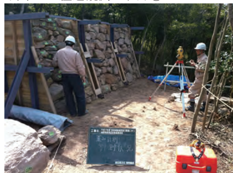
写真 68 変形試験状況②
