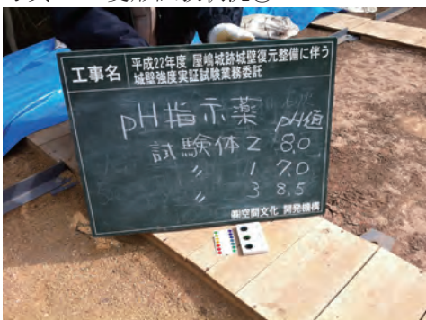
写真 69 盛土材の pH 試験状況①
