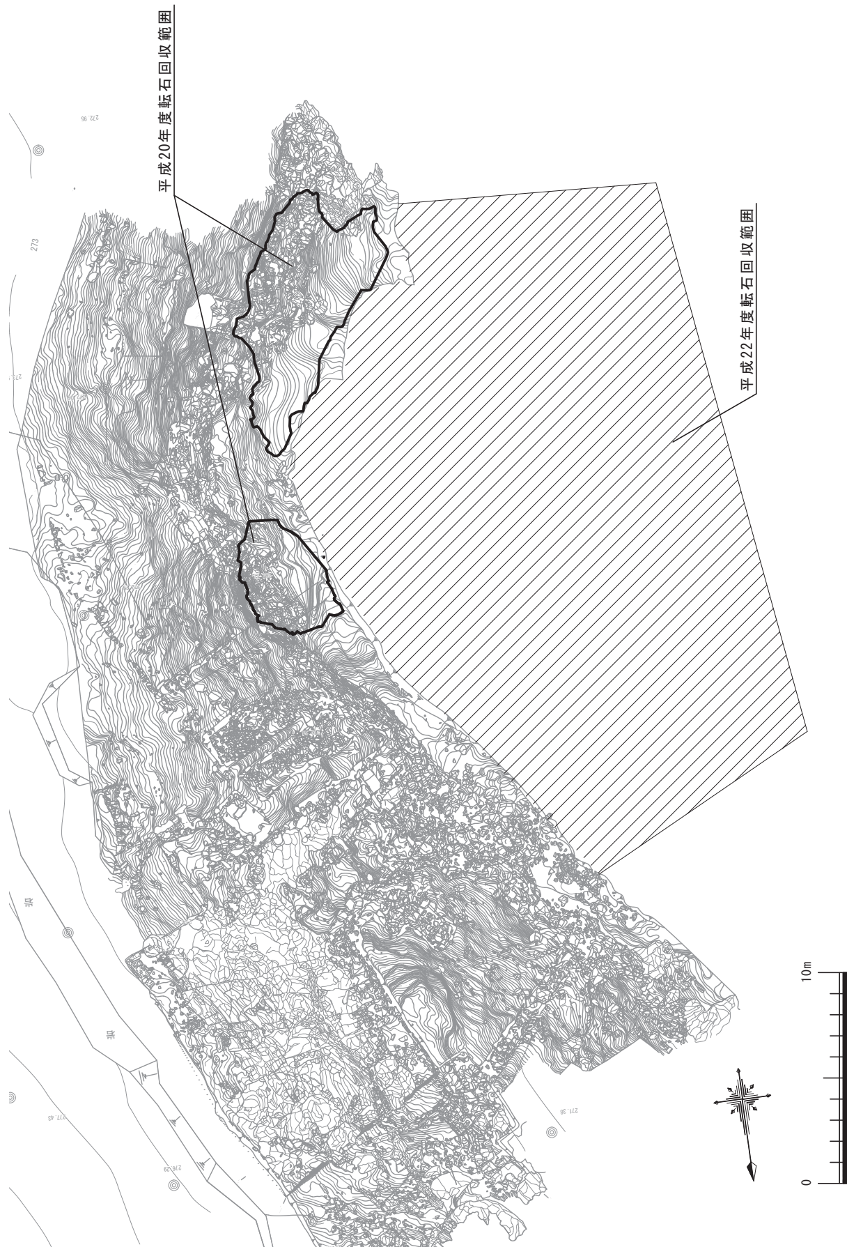
図 151 崩落石及び転石回収範囲
