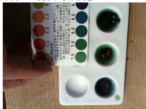
写真 70 盛土材の pH 試験状況②
