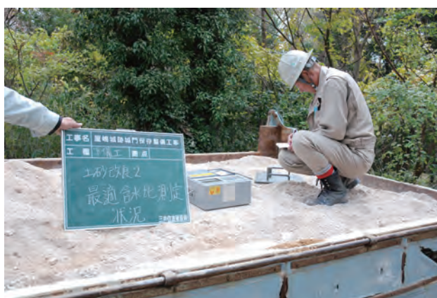
写真 130 最適含水比測定状況
