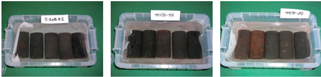
各石材の見かけ比重を測定後、強化剤は下記の3種類選択して1日間浸漬法にて含浸した。 写真59 含浸状況
