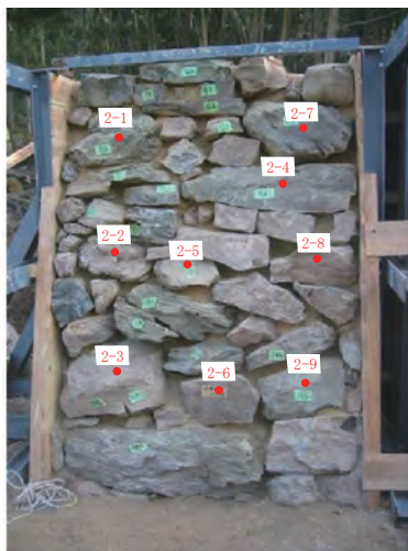
図 120 試験体測定箇所と荷重
