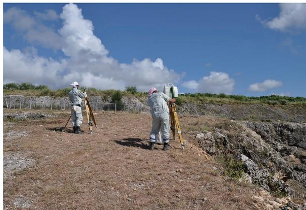
2 3Dレーザー計測作業状況
