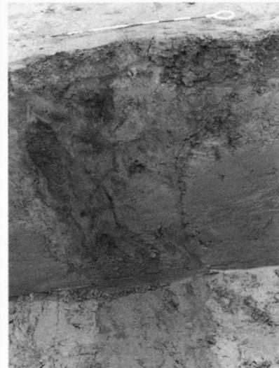
写真4 打出遺跡の砂脈の断面形(その2)
