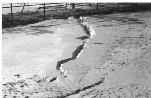
写真1 兵庫県南部地震で流れ出した噴砂
