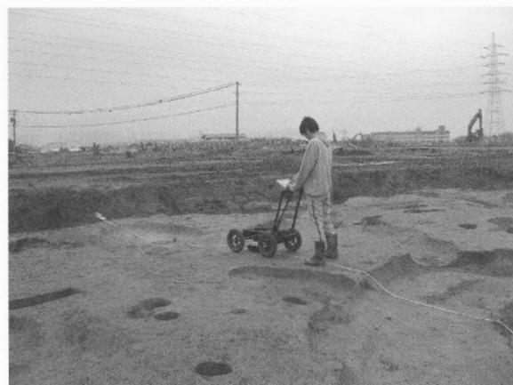
写真2 地中レーダ探査風景
