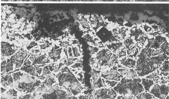
Photo. 6 二条凸带铸造斧刃部側小片試料の顕微鏡組織
