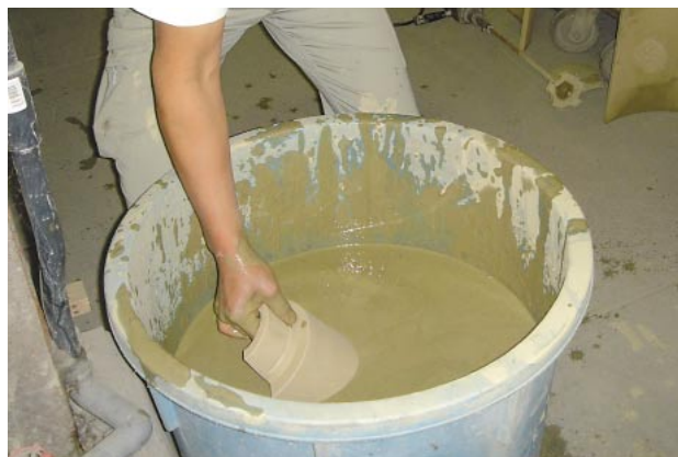
乾燥した瓦に、鉄分の多い粘土を塗布する
