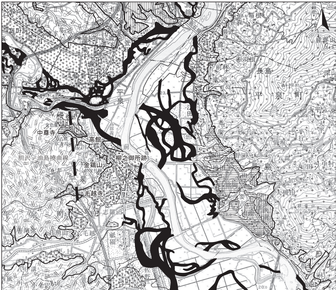
5万分の1地形図「水沢」一関に、地質図と野中氏の地形分類図を簡略化して編集
