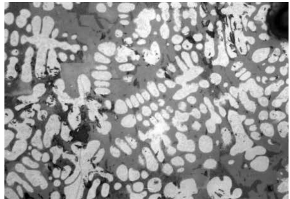
鉄滓顕微鏡組織写真 No.2-2 × 400
