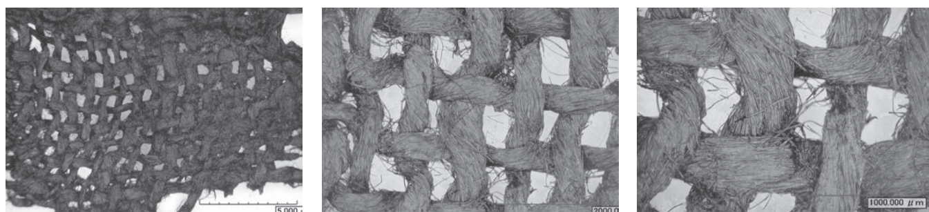
図102 No. 7の織りが粗い(目が粗い)部分の観察記録 (左から×20、×60、×100)
