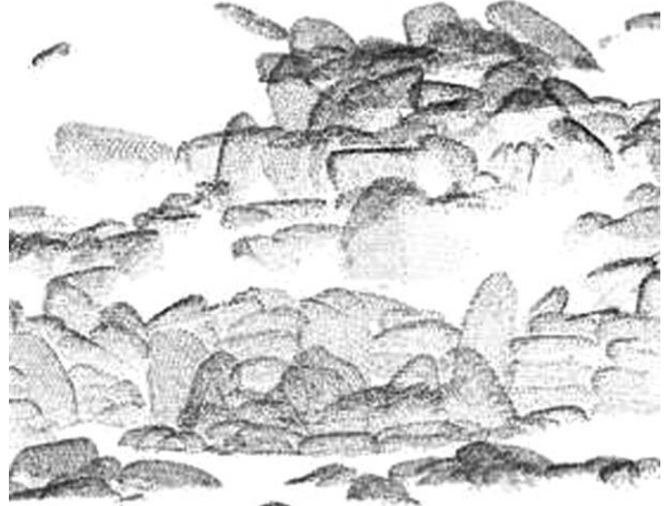
②3次元レーザーにより計測した遺構
