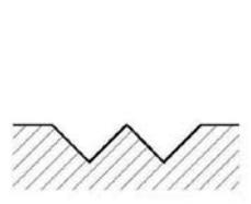
図7 鎬付き葉研彫断面図
