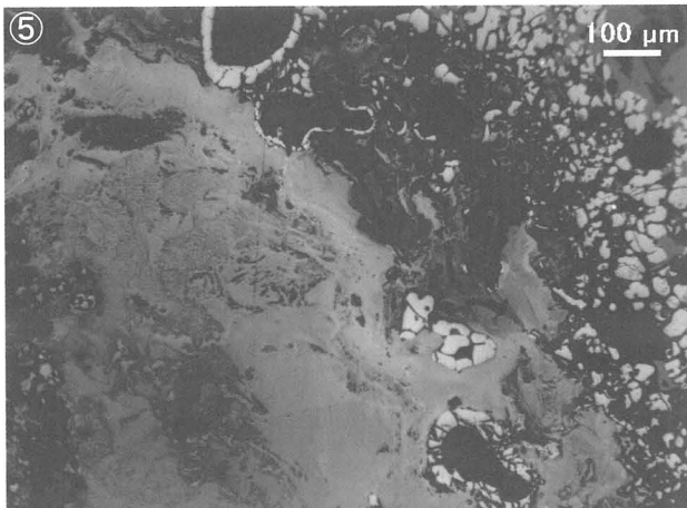
Photo. 5 羽口・椀形鍛冶滓の顕微鏡組織
