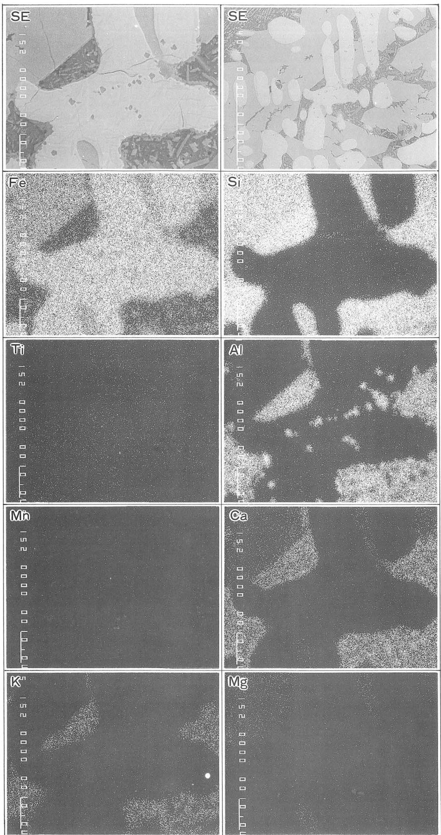
Photo. 8 深田河内遺跡ST3床面出土 梶形鍛冶爐(TUY - 4)の特性X線像(60%)
