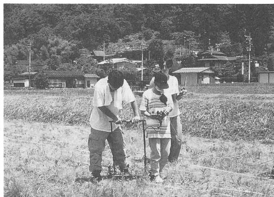
第1図 富山大学理学部チームによる遺跡探査（二極法電気探査）
