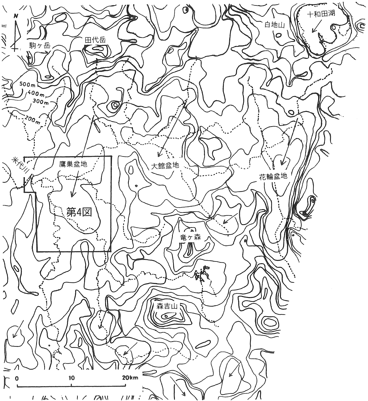
第3図 鷹巣盆地周辺の接峰面図 2 km の谷を埋谷、等高線間隔は 100 m
