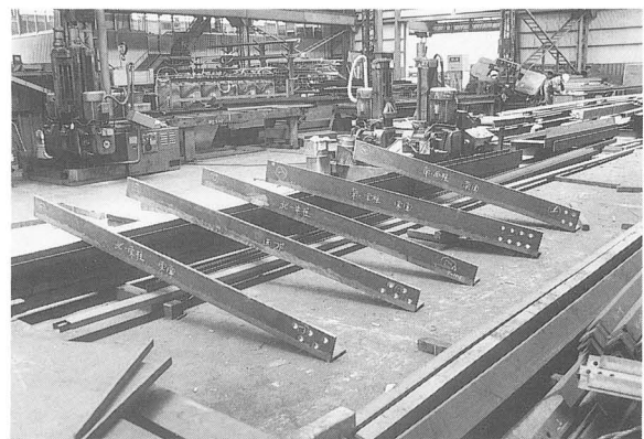
写真-79 補強用鉄骨 (加工)
