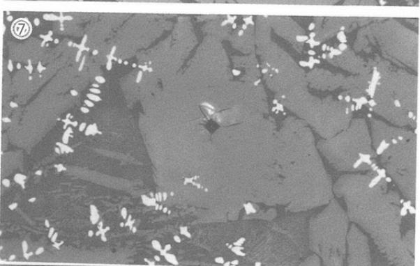
Photo 6 製鍊滓の顕微鏡組織
