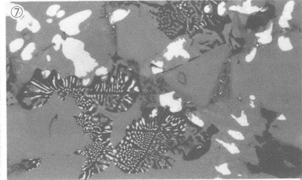
Photo 7 製鍊滓の顕微鏡組織
