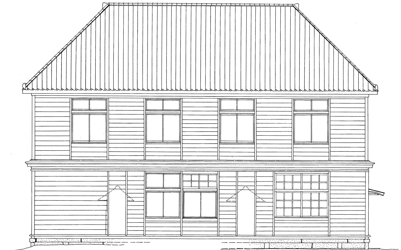
第6図 庁舎外觀実測図1 (上:南面 下:北面) 北面礎石の一部は実測不能のため省略。屋根も後補した。
