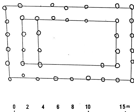
(2) SB 02建物跡(図-32) 桁行6間の整形な建物跡である。出土遺物から16世紀中葉頃と認められている。柱の並びは明解であり、柱間寸法もきれいに整っている。桁行では5.0・6.6・6.6・6.6・6.6・5.0尺の36.4尺となり、梁行でも5.0・6.6・6.6・6.6・5.0尺の29.8尺となっているものである。
