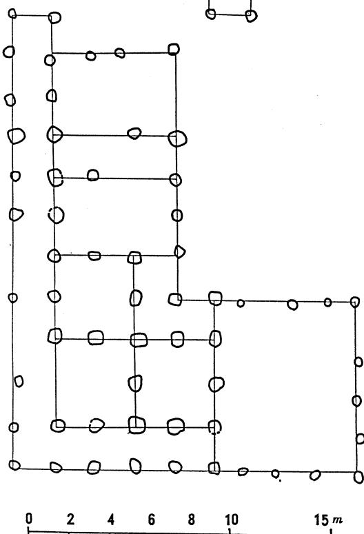
に仕切られている。柱間寸法は、桁行で 5.0 • 6.6 • 6.6 • 6.6 • 6.6 • 7.0 尺の 45.0 尺となり、梁行では 6.0 • 7.0 尺の 13.6 尺と計測されるようである。
