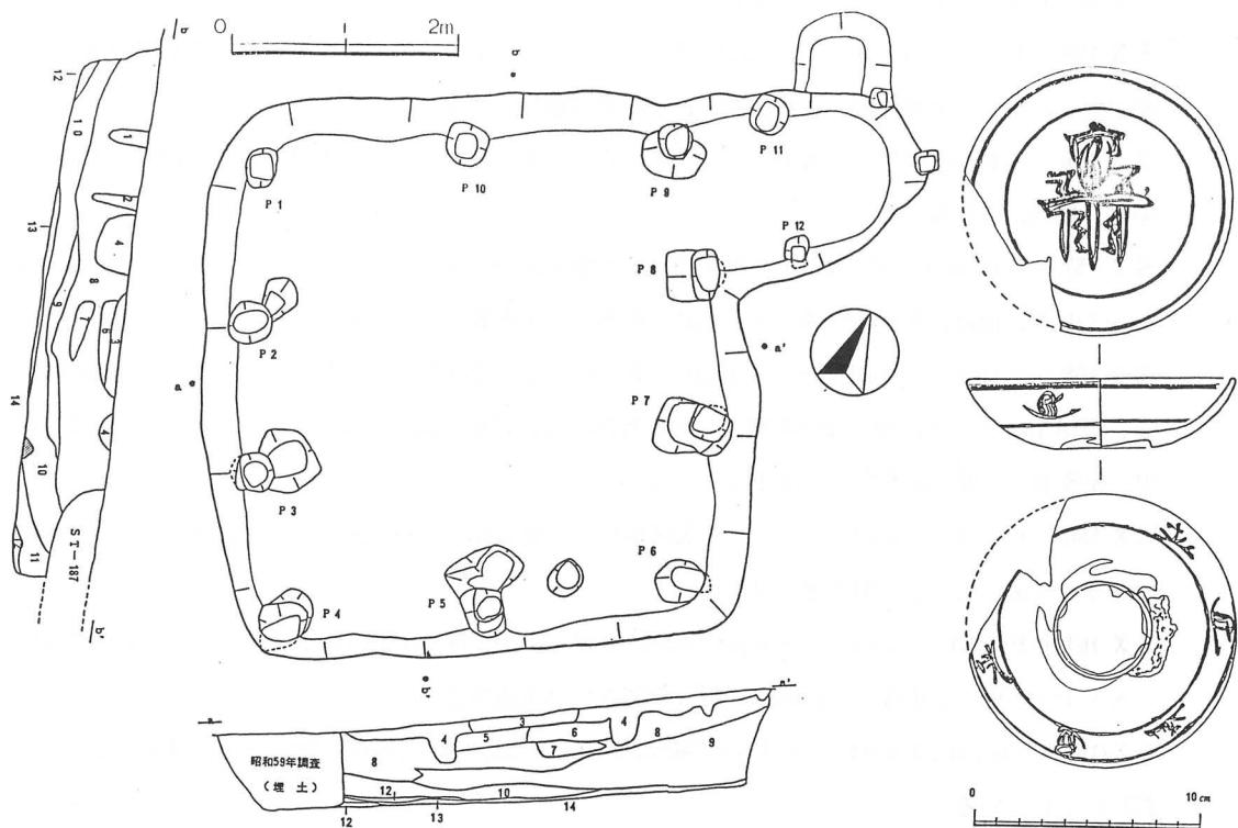
**S T 232** ( PL.10、Fig.28、Ch.35) —— G 45区検出。二つの遺構が重複していたため任意にAとBに分けた。S T 232 Aは、長軸 270 cm、短軸 230 cm、深さ 45cmで北壁東側に舌状スロープの張り出しを有する。S T 232 Bは、長軸 220 cm、短軸 203 cm、深さ 53cmで張り出しあらない。A・Bともに明確な柱穴配置は認められず、相方の新旧関係も明確でない。出土遺物としては染付、白磁、天目、唐津、瓦器、苧引金、鉄釘、砥石がある。
