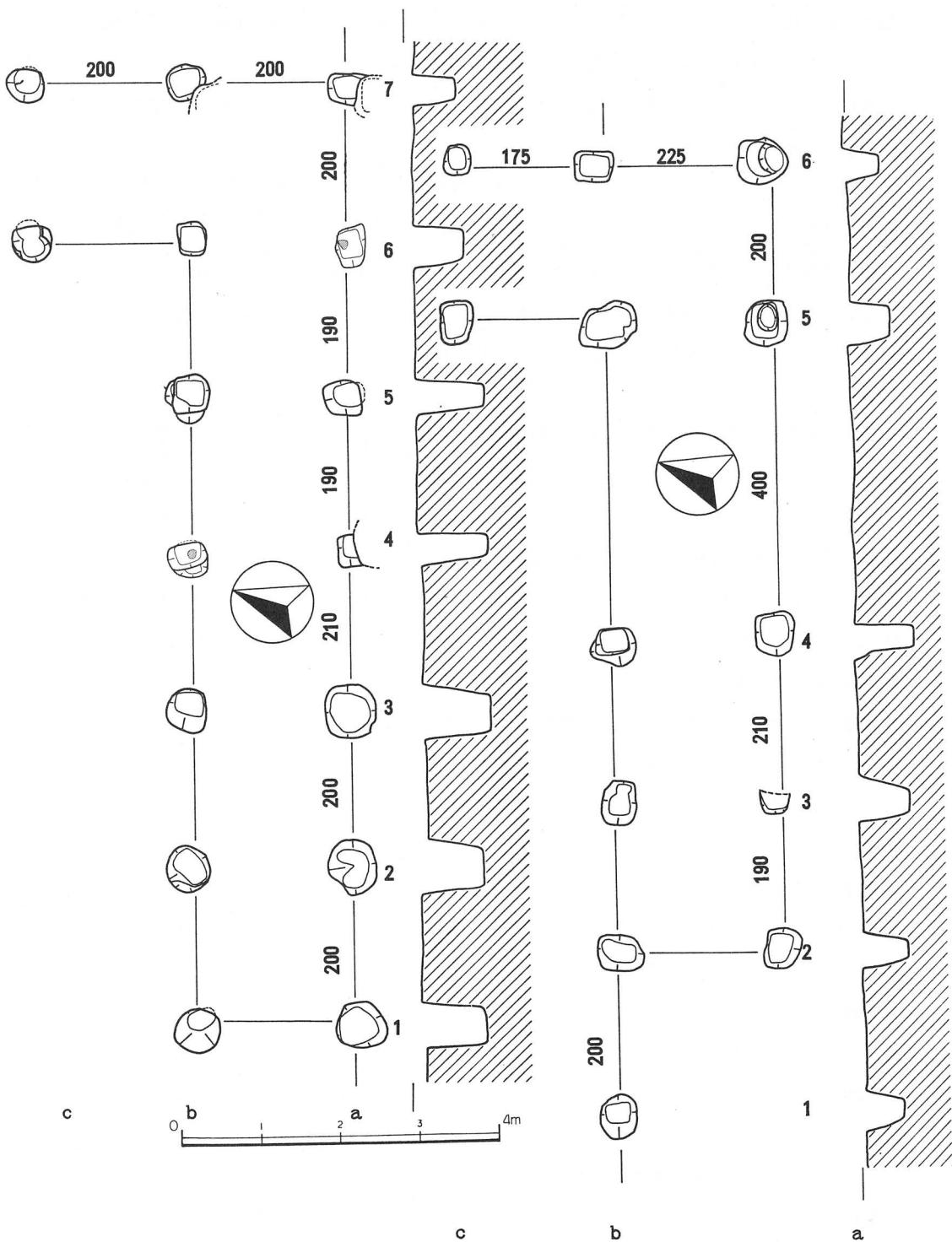
**S B 57** ( PL.14、Fig.37、Ch.52 ) —— F・G41区検出。同地区から検出された柵形遺構に伴う二脚門の跡と推定される。Fig.37のP1とP2がこれであり、径約100cm深さ160～180cmの柱穴が9尺(272cm)から10尺(303cm)の幅で配置され、柵形のスロープ中間に位置している。柱穴からの出土遺物はなかったが、柵形遺構自体が城館期全時期の遺物を出土することから、本遺構も城館期全般にわたって使用されたと考えられる。
