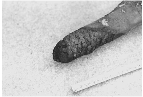
S X 42 構造材 (炭化部分)
