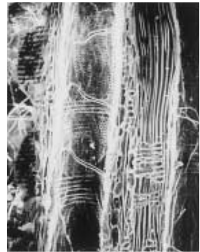
2c コナラ節(放射断面) 試料No.6 bar:0.5mm
