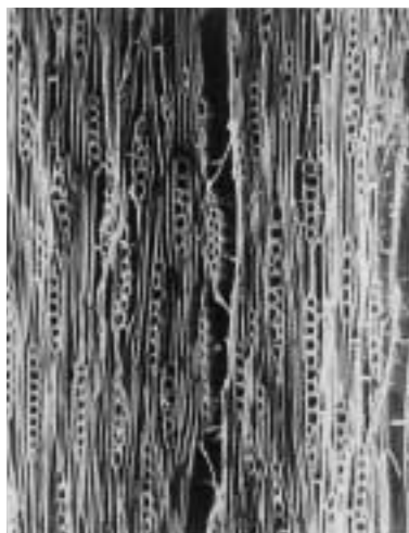
3b クリ(接線断面) 試料No.7 bar:0.5mm
