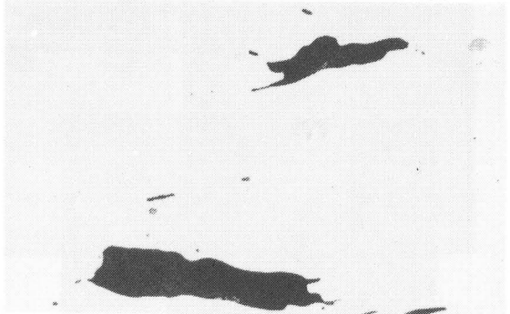
PG 5. 刃先部に多量に見られた非金属介在物
