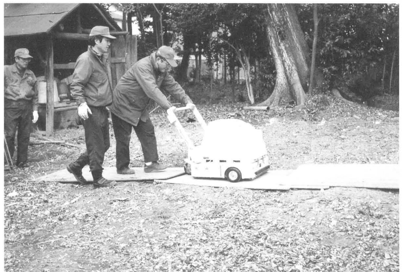
地中レーダー探査風景
