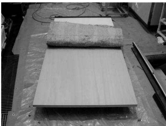
fig.245 転写土層および専用パネル
