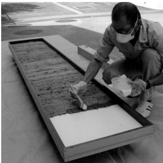
fig.247 剥落止め用樹脂塗布作業
