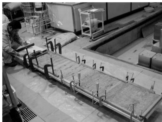
fig.246 転写土層シート貼付け作業
