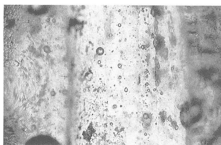
図1. ガラス小玉の顕微鏡写真 気泡や孔の状態が観察される。
