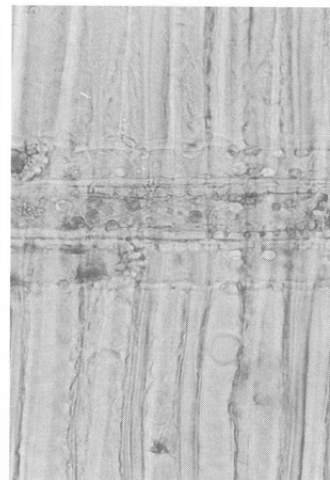
1c.モミ属(放射断面) BMJ-44 bar:0.05mm
