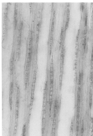
5b. ヤナギ属 (接線断面) BKN-18 bar:0.2mm
