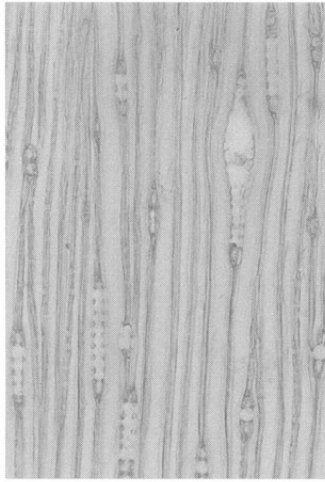
4b. マツ属複維管束亜属 (接線断面) BMY-37 bar:0.2mm
