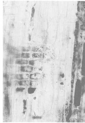
7c. クリ (放射断面) BKN-3 bar:0.1mm
