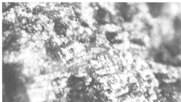
2B 刃部付近の摩耗・光沢痕(2Aの拡大) × 45
