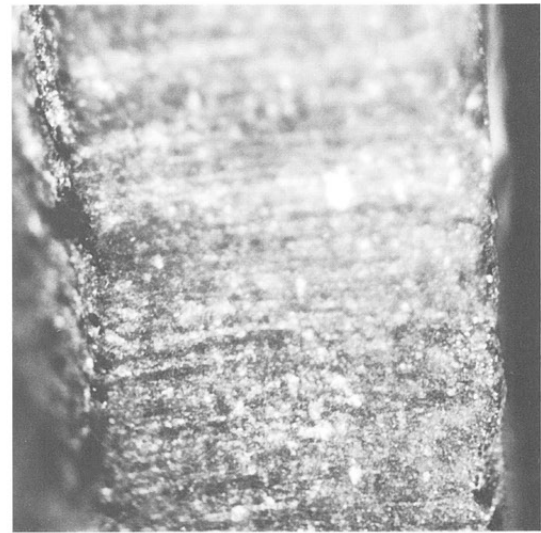
2B 2B.錐部の摩耗・線状痕(2Aの拡大) ×22.5
