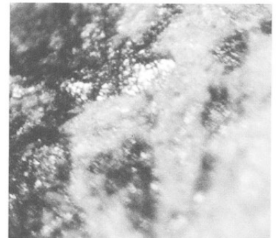
1C. 刃部の摩耗・光沢痕(1Bの拡大) ×60
